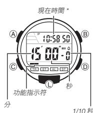
倒數定時器可以在 1 秒鐘至 24 小時的範圍內設定。倒數到零時鬧鈴鳴響 10 秒鐘，按任意鈕可中途停止鬧鈴音。
