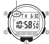
在計時功能中，按住 **D** 鈕約兩秒鐘可開啟（振動鬧鈴開啟指示符出現）或解除（振動鬧鈴開啟指示符消失）振動鬧鈴。
