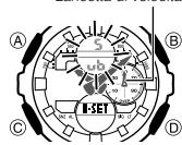
Posizione corretta della lancetta di velocità
