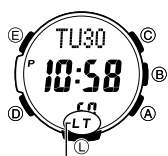
Indicateur de commutateur d'éclairage automatique en service
