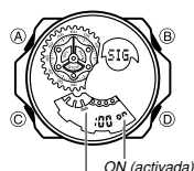
ON (activada) Indicador de señal horaria activada
