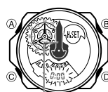
Posiciones correctas de las manecillas de hora y de minutos
