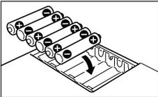
4. Coloque un juego de seis pilas nuevas en el compartimiento de pilas, asegurándose de que sus extremos positivo (+) y negativo (-) se orienten en las direcciones correctas. Asegúrese de usar pilas alcalinas.
