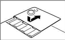
3. Si está reemplazando las pilas, retire las seis pilas usadas.
