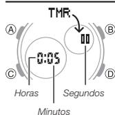
El temporizador de cuenta regresiva puede ajustarse en un rango de un minuto a 24 horas. Suena una alarma cuando la cuenta regresiva llegue a cero.
