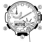
Indicador del interruptor de luz automática activado
