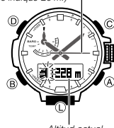
Diferencia de altitud (Ubicación de referencia, de manera que se indique ±0 m.)
