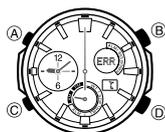
• Cuando aparezca **ERR** mientras está realizando una operación de medición en un modo de sensor, vuelva a iniciar la medición. Si en la pantalla superior aparece **ERR** nuevamente, podría indicar que hay un problema con el sensor.
