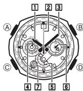
Las operaciones de los botones se indican mediante las letras (A) a (D) mostradas en la ilustración.
