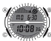
El reloj tiene un panel EL (electroluminiscente) que ocasiona que la presentación entera se ilumine para una fácil lectura en la oscuridad.
