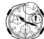
Movimiento de la manecilla durante la operación de tiempo transcurrido
