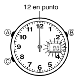
Posición inicial de manecilla analógica correcta
