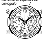
Manecilla de segundos de hora normal Posición inicial correcta de la manecilla de segundos de hora normal y manecilla de segundos del cronógrafo
