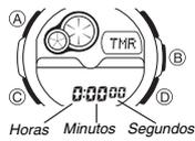
Puede ajustar el temporizador de cuenta regresiva dentro de un rango de un minuto a 100 horas. Suena una alarma cuando la cuenta regresiva llega a cero.
