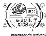
Indicador de activación del interruptor de luz automático
