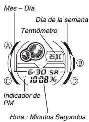
Utilice el modo de hora normal para ver y ajustar la hora y fecha actuales. Este reloj presenta indicaciones separadas para la hora normal digital y analógica. Los procedimientos para ajustar la hora digital y la hora analógica son diferentes.
