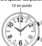
Posición inicial de manecilla de segundos correcta
