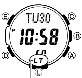
Indicador del interruptor de luz automática activado
