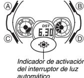
Dos LED (diodos emisores de luz) iluminan la esfera del reloj para una fácil lectura en la oscuridad. El interruptor de luz automático del reloj ilumina la esfera cuando el reloj es inclinado en ángulo hacia su cara.
