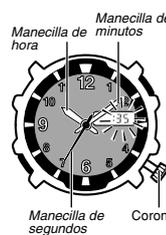
1. Tire de la corona hacia afuera de manera que los dígitos de segundos se encuentren destallando. Este es el modo de ajuste de hora.
