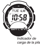
Indicador de carga de la pila
