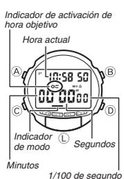
El modo de cronógrafo le permite medir el tiempo transcurrido, tiempos fraccionados y dos tiempos de llegadas a meta. La gama de medición del cronógrafo es de 23 horas, 59 minutos y 59,99 segundos. También puede tener un sonido de alarma cuando se alcanza la hora objetivo. El modo de cronógrafo también presenta una función de inicio automático.
