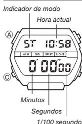
El modo cronómetro le permite medir el tiempo transcurrido, los tiempos fraccionarios, y dos llegadas a meta. El rango del cronómetro es de 23 horas, 59 minutos, 59 segundos.
