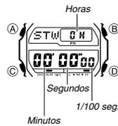
El cronógrafo le permite medir el tiempo transcurrido, tiempos fraccionados y dos llegadas a meta.
