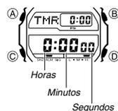
Puede ajustar el temporizador de cuenta regresiva dentro de un rango de 1 minuto a 24 horas. Suena una alarma cuando la cuenta regresiva llega a cero.
