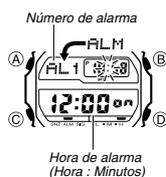
El modo de alarma le permite elegir entre cuatro alarmas que suenan una sola vez y una alarma despertador. También puede utilizar el modo de alarma para activar y desactivar la señal horaria (SIG).
