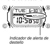
Al activar la alerta de destello, la iluminación parpadea para las alarmas, la señal horaria, la alarma de cuenta regresiva, y el inicio automático del cronógrafo (ST1).
