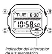
Este reloj dispone de un panel EL (electroluminiscente) que ilumina la presentación entera para facilitar la lectura en la oscuridad. El interruptor de luz automática del reloj activa automáticamente la iluminación de la presentación cuando el reloj es inclinado en ángulo hacia su cara para leer.
