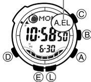
La presentación del reloj se ilumina mediante el panel EL (electroluminiscente) para una fácil lectura en la oscuridad. El interruptor de luz automático del reloj, activa automáticamente la iluminación cuando inclina el reloj hacia su cara.
