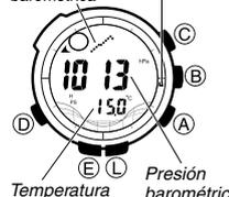
Al presionar **ⓑ** en el modo de hora normal o en cualquiera de los otros modos de sensor, se ingresa al modo de barómetro/termómetro y se inicia la medición automática de la presión barométrica y temperatura.
