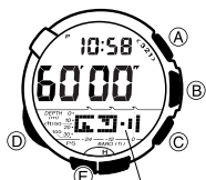
Indicador de activación del zumbador de progreso
