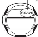
Cuando se encuentra activada, la función de ahorro de energía coloca automáticamente el reloj en una condición de letargo siempre que se lo deja en un lugar oscuro durante un cierto tiempo. La tabla siguiente muestra la manera en que son afectadas las funciones del reloj por la función de ahorro de energía.
