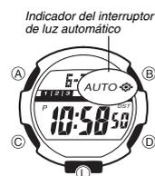
El reloj tiene un panel EL (electroluminiscente) que ilumina la presentación entera para una fácil lectura en la oscuridad. El interruptor de luz automático del reloj ilumina la presentación cuando el reloj es inclinado en ángulo hacia su cara.
