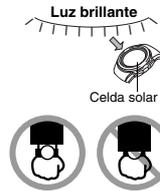
La electricidad generada por la celda solar del reloj es almacenada por una pila incorporada. Dejando o usando el reloj en un lugar en donde no sea expuesto a la luz ocasiona que la pila se agote. Asegúrese de que el reloj sea expuesto a la luz siempre que sea posible.
