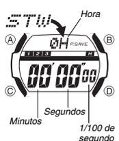
El cronógrafo le permite medir el tiempo transcurrido, tiempos fraccionados y dos llegadas a meta.
