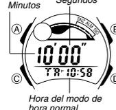
El temporizador de cuenta regresiva puede ajustarse dentro de una gama de 1 minuto a 60 minutos. Una alarma suena cuando la cuenta regresiva llega a cero. El temporizador de cuenta regresiva tiene dos modos: repetición automática y tiempo transcurrido, y un zumbador de progreso va señalando el progreso de la cuenta regresiva. Todo esto hace que el temporizador de cuenta regresiva sea una herramienta valiosa para medir el tiempo al inicio de una carrera de Yates.
