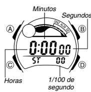
El cronógrafo le permite medir el tiempo transcurrido, tiempos fraccionados y dos llegadas a meta.
