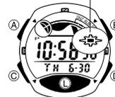
La presentación del reloj se ilumina mediante un diodo LED (diodo emisor de luz) y un panel de guía de luz para una fácil lectura en la oscuridad. El interruptor de luz automático del reloj, activa automáticamente la iluminación cuando inclina el reloj hacia su cara.
