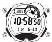
La presentación del reloj se ilumina mediante un diodo LED (diodo emisor de luz) y un panel de guía de luz para una fácil lectura en la oscuridad. El interruptor de luz automático del reloj, activa automáticamente la iluminación cuando inclina el reloj hacia su cara.
