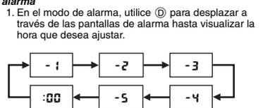
1. En el modo de alarma, utilice **(D)** para desplazar a través de las pantallas de alarma hasta visualizar la hora que desea ajustar.
