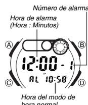
Se pueden ajustar cinco alarmas diarias independientes. Cuando una alarma se encuentra activada, el tono de alarma suena cuando se llega a la hora de alarma. Una de las alarmas puede configurarse como una alarma de despertador o una alarma que suena una vez, mientras las otras cuatro son alarmas que suenan una sola vez. También puede activar la señal horaria que ocasiona que el reloj emita dos zumbidos a cada hora sobre la hora ajustada.
