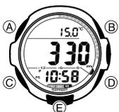
En el modo de altímetro, mantenga presionado (D) durante alrededor de un segundo hasta que el reloj emita dos zumbidos. Esto indica que un registro de la lectura de altitud ha sido almacenado en la memoria.
