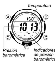
Presionando **(E)** en el modo de hora normal o en cualquiera de los otros modos de sensor ingresa el modo de barómetro/termómetro y automáticamente inicia la medición de presión barométrica y temperatura.
