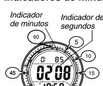
Los indicadores de minutos y segundos indican gráficamente los valores de tiempo transcurridos en el modo de cronógrafo. El indicador de segundos actúa como la manecilla de segundos de un cronógrafo analógico, y se mueve sobre la presentación para indicar la cuenta de segundos. El indicador de minutos actúa como la manecilla de minutos de un cronógrafo analógico, y se mueve sobre la presentación para indicar la cuenta de minutos.
