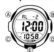
1. En el modo de alarma, utilice (D) para desplazar a través de las pantallas, hasta visualizar la alarma cuya hora desea ajustar.
