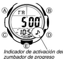
Presionando (A) mientras el tiempo de inicio de la cuenta regresiva se encuentra sobre la presentación, o mientras la operación del temporizador de cuenta regresiva se encuentra en progreso en el modo de temporizador de cuenta regresiva, alterna entre la activación (se visualiza ♪) y desactivación (no se visualiza ♪) de la operación del zumbador de progreso.
