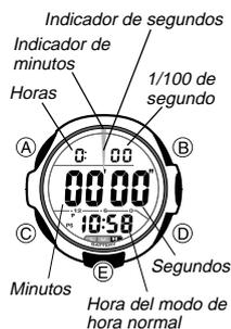
El cronógrafo le permite medir el tiempo transcurrido, tiempos fraccionados y dos llegadas a meta. La presentación de los indicadores de minutos y segundos puede activarse y desactivarse.
