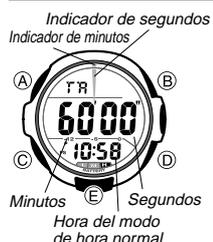
El temporizador de cuenta regresiva puede ajustarse dentro de una gama de 1 minuto a 60 minutos. Una alarma suena cuando la cuenta regresiva llega a cero. Una función de repetición automática ocasiona que la cuenta regresiva se reinicie automáticamente cuando se llega al final de la cuenta regresiva, y un zumbador de progreso va señalando el progreso de la cuenta regresiva.
