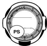
Si el indicador PS se encuentra sobre la presentación (ya sea destellando o fija), significa que la presentación se queda en blanco debido a que la función de ahorro de energía del reloj ha desactivado la presentación para conservar energía. La función de ahorro de energía desactiva automáticamente la presentación y coloca el reloj en una condición de letargo, siempre que se deja el reloj en un lugar oscuro durante un cierto período de tiempo.
