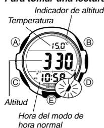
Presionando (D) en el modo de hora normal o en cualquiera de los otros modos de sensor, ingresa el modo de altímetro. El reloj inicia automáticamente la medición de altitud.
