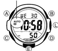
La luz de fondo utiliza un panel EL (luz electroluminiscente) que ocasiona que la pantalla entera se ilumine para una fácil lectura durante la oscuridad. El interruptor de luz automático ocasiona que la luz de fondo se active cuando el reloj es inclinado en ángulo hacia su cara.
