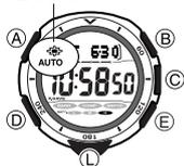
La luz de fondo utiliza un panel EL (luz electroluminiscente) que ocasiona que la pantalla entera se ilumine para una fácil lectura durante la oscuridad. El interruptor de luz automático ocasiona que la luz de fondo se active cuando el reloj es inclinado en ángulo hacia su cara.
