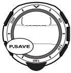
Si el indicador **P.SAVE** se encuentra sobre la presentación (ya sea destellando o fija), significa que la presentación se queda en blanco debido a que la función de ahorro de energía del reloj ha desactivado la presentación para conservar energía. La función de ahorro de energía desactiva automáticamente la presentación y coloca el reloj en una condición de letargo, siempre que se deja el reloj en un lugar oscuro durante un cierto período de tiempo.
