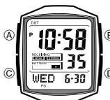
La luz de fondo utiliza un panel EL (electroluminiscente) que ocasiona que la pantalla entera se ilumine para una fácil lectura en la oscuridad.
