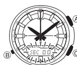
Korrekte Stellung des Sekundenzeigers
