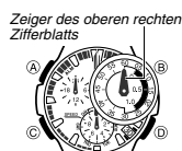
Korrekte Grundstellung des Zeigers des oberen rechten Zifferblatts
