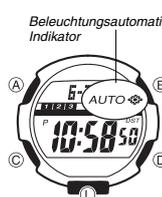
Die Armbanduhr besitzt ein EL (Elektrolumineszenz)-Panel, das zur besseren Ablesbarkeit im Dunkeln die gesamte Anzeige leuchten lässt. Die Beleuchtungsautomatik schaltet die Beleuchtung des Displays automatisch ein, wenn Sie die Armbanduhr in einem bestimmten Winkel halten.
