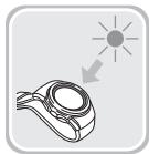
当您佩戴手表时，确保衣袖不会阻挡光线照射到表面（太阳能板）。即使表面被部分遮挡，发电效率也会降低。
