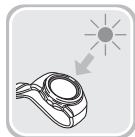
当您佩戴手表时，确保衣袖不会阻挡光线照射到表面（太阳能板）。即使表面被部分遮挡，发电效率也会降低。
