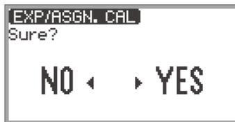
5. Para iniciar a calibração, toque na direita (YES) do anel de toque.
