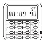
Un segnale conferma l'operazione di avvio/interruzione. Il segnale acustico suona a intervalli di 10 minuti. (Gamma di funzionamento) L'indicazione del cronometro sul display è limitata a 23 ore, 59 minuti e 59,99 secondi. Dopodiché, essa può essere azzerata e riavviata. È possibile visualizzare le cifre delle ore premendo il pulsante (+).
