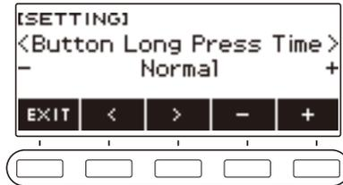
**5. Ruotare il selettore o usare - e + per cambiare il valore del tempo di pressione prolungata del pulsante.**
