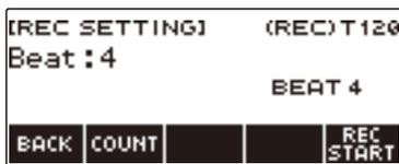
**5. Ruotare il selettore per cambiare il valore dei battiti.**
