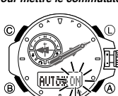
Indicateur de commutateur d'éclairage automatique en service
