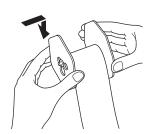
**6** Insérez la bobine réceptrice derrière l'imprimante, au-dessus du rouleau de papier.
