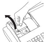
**3** Insérez le rouleau dans l'espace derrière l'imprimante en veillant à ce que le papier soit alimenté par le bas du rouleau.
