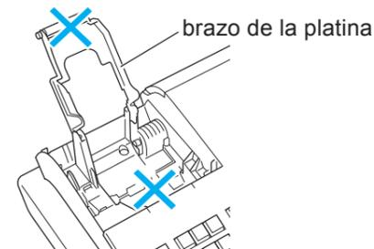
5. Vuelva a colocar la cubierta de la impresora, pasando el extremo inicial del papel por la ranura de corte. Arranque el exceso de papel.
