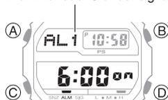
3. Drücken Sie (A), um den angezeigten Alarm oder das Stundensignal auszuschalten.
