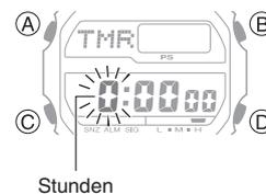
3. Verwenden Sie (B) und (D), um die Stundeneinstellung des Timers zu ändern.
