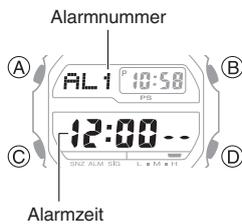
3. Halten Sie (A) mindestens zwei Sekunden lang gedrückt. Dadurch blinken die Stunden.
