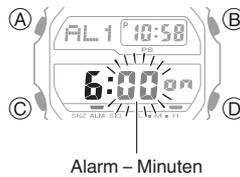
6. Verwenden Sie (B) und (D) zum Ändern der Minuteneinstellung.
