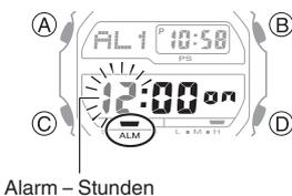
4. Verwenden Sie (B) und (D) zum Ändern der Stundeneinstellung.
