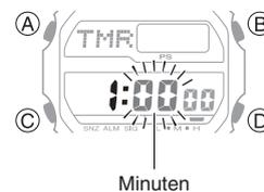
5. Verwenden Sie (B) und (D), um die Minuteneinstellung des Timers zu ändern.
