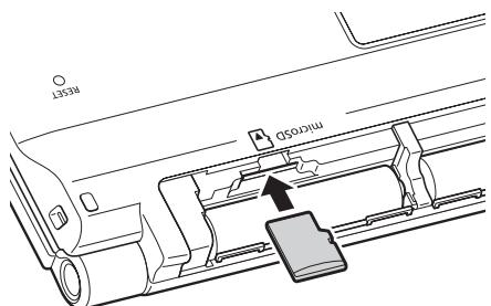
**3** 按图示方向将 microSD 存储卡牢固地插入到 microSD存储卡插槽中。
