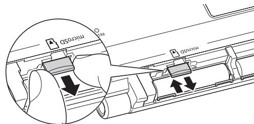
**4** 手持microSD存储卡的左右两端，将卡拔出。
