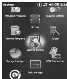
2. 轻拍 [Scanner Setting] 图标。屏幕上显示设定画面，如图所示。
