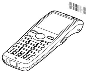
2. 激光器发射光线扫描条形码。如果扫描正常完成，指示灯 2 显示绿光并发出蜂鸣声。
