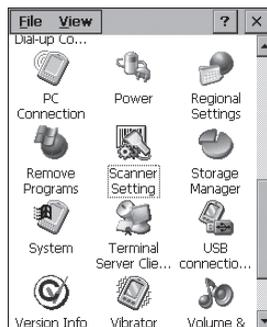
2. 将焦点移到 [Scanner Setting] 图标，然后按确定键。便会出现右侧的显示。
