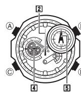
2. 确认 **④ 左子盘针** 的基准位置正确后，按 **(C)** 钮。此时手表进入 **⑤ 右子盘针** 的基准位置调整状态。
