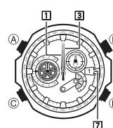
5. 确认 **① 时针及 ③ 分针** 的基准位置正确后，按 **(C)** 钮。此时手表进入日期的基准位置调整状态。
