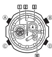
4. 确认 **② 秒针** 的基准位置正确后，按 **(C)** 钮。此时手表进入 **① 时针及 ③ 分针** 的基准位置调整状态。
