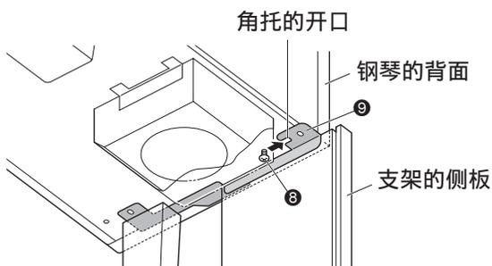
9. 首先，用两个螺丝 ④ 将钢琴的背部（左右两侧）固定在支架上。然后，用两个螺丝 ④ 固定钢琴的前部（左右两侧）。
