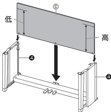
4. 将背板③的左端固定在侧板①的角托⑤上，而将右端固定在侧板②上。半拧紧两个⑧螺丝，暂时将背板固定到位。
