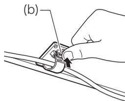
2. 如图所示调整踏板插头的方向，将插头插入钢琴底部的踏板接口内。
