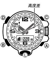
若您指定了參考高度，手錶的秒針將指示現在高度與參考高度之間的高度差。手錶每次取得新的高度測量值時更新顯示的高度差。
