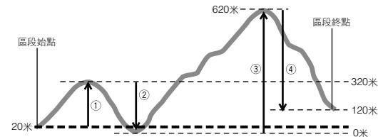
上圖中介紹的登山例中測高計功能測量的總上升高度及總下降高度如下所述進行計算。
