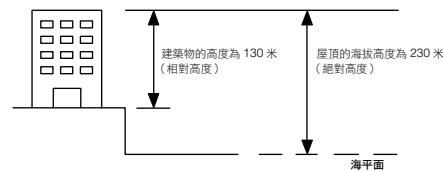
為了讓測量值最為精確，建議在進行測量之前根據當地的高度（垂直高度）標識校準手錶（第 Ch-60 頁）。
