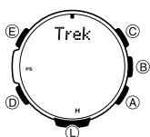
在測高計功能中，按住 ④ 鈕至少五秒鐘。首先，Trek Hold 在畫面上閃動。之後，Hold 消失，而表示測量的經過時間的指針 (■) 出現在 12 時位置。當 Hold 消失時鬆開 ④ 鈕。
