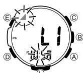
在訊號接收過程中，訊號強度指示符如下所示顯示電波訊號的強度。
